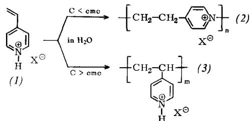
Die kritischen Micellkonzentrationen (cmc) der 4-VP-Salze sind stark vom Gegenion abhängig. Sie können durch Fremdsalzzusätze erniedrigt werden. Parallel dazu wird die „kritische Polymerisationskonzentration“ (cpc), der Beginn der Polymeratbildung, verringert.
